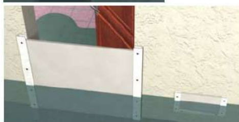
Batardeau de porte et capot amovible limitant la pénétration de l'eau.
