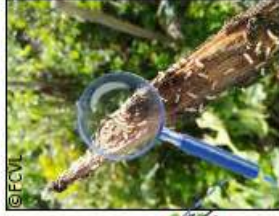
Bois extérieur attaqué par des termites. Contamination par le sol
